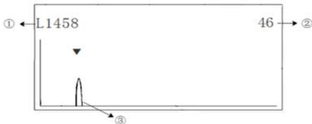
Figura 5 LCD interface de onda da figura do Transmissor de Nível de Radar.
